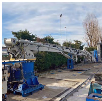
Arm test bench: a fatigue test is performed on the arms extended horizontally. At this moment, in preparation to go "under the knife," the K56L is being readied for testing. Banco prova bracci: si effettua una prova di fatica sui bracci estesi in orizzontale, in questo momento ad essere in preparazione per andare "sotto i ferri" è il K56L
