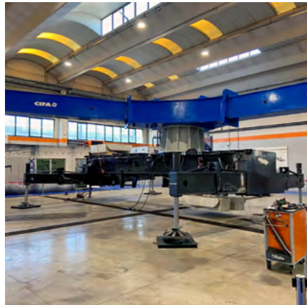
Test bench for frames, also nicknamed tripod (due to the three cylinders that move it), in the testing phase of the frame of a crane. Banco prova per telai, soprannominato anche tripode (dai 3 cilindri che lo movimentano), in fase di test il telaio di un'autogrù
