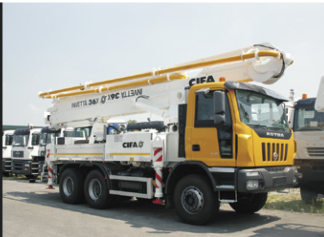
Pompa PA806D8 con braccio 4 sezioni 36 m PA806D8 truck pump with 4 sections 36 m placing boom
