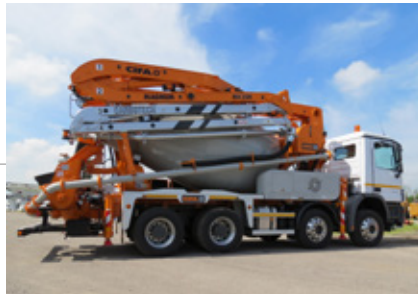
MK25H, la prima betonpomba con il braccio in tecnologia al carbonio MK 25H, the first concrete pump with a boom with carbo technology
