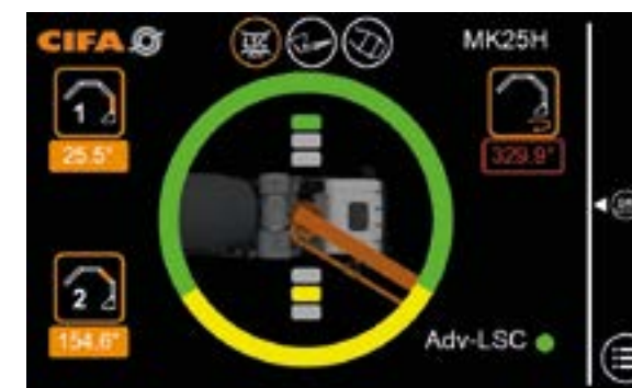
Die Abstützüberwachung LSC (Light Stability Control) ist für alle Modelle erhältlich.
